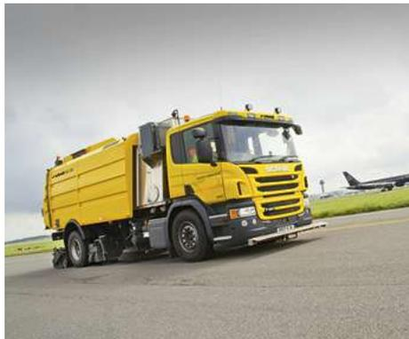
Las barras de pulverización adicionales convierten a la Schmidt AS 990 en una máquina de limpieza de soportes (ASC 990).
