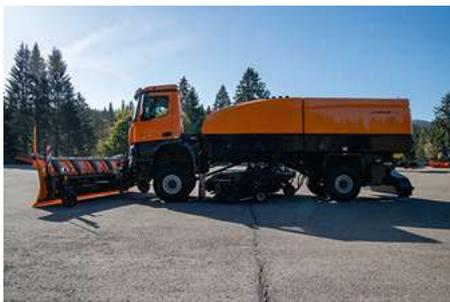
В стандартной комплектации CJS легко устанавливается на шасси Mercedes-Benz Arcos 2036. Диаметр разворота этого транспортного средства составляет 18 метров, а для повышения маневренности предусмотрена возможность установки дополнительного рулевого управления задней осью. Базовое оборудование и уровень соответствия стандартам выброса выхлопных газов базового шасси выбираются индивидуально для клиента и соответствующей страны.
