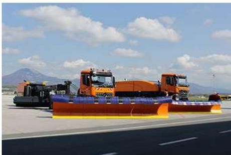
Un déneigement propre et agressif est obtenu avec les lames chasse-neige pour aéroport MS Tarron, par ex. la MS 56.2 NA. La lame multi-panneaux MS est conçue pour un essuyage efficace et éjection rapide de la neige dans les aéroports et offre un résultat de déneigement inégalé grâce à ses segments de bandes d'usure en polyuréthane qui peuvent être complétés par des bandes de finition (option).
