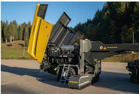
Le moteur entraîne les pompes hydrauliques pour le fonctionnement et la commande de l'unité de balayage et de l'unité de soufflage. La lame de déneigement est commandée par un système hydraulique entraîné par le moteur du véhicule porteur. Le châssis hydropneumatique de la TJS/TJS-C offre à l'opérateur un confort supplémentaire sur le terrain.
