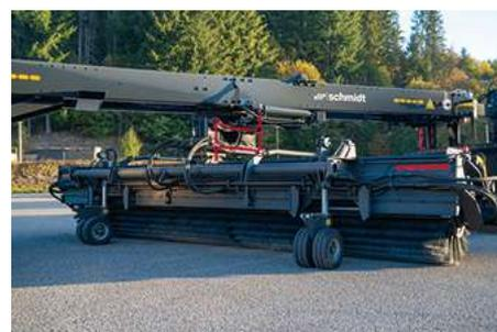
Сдвоенные опорные колеса обеспечивают низкий уровень шума и вибрации, стабильно высокое качество подметания, точный выброс снега, идеальную чистовую обработку и максимальную безопасность. Аэродинамическая направляющая спойлера и функции автоматической регулировки спойлера и скорости вращения щеток в зависимости от износа позволяют подметально-продувочной машине осуществлять аккуратную уборку. Прочная конструкция обеспечивает оптимальные рабочие характеристики и максимальную безопасность.
