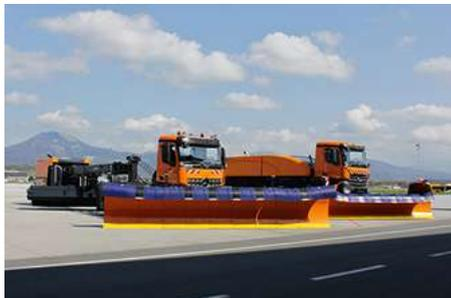
Эффективная и быстрая уборка может осуществляться с помощью снегоборочных отвалов компании Schmidt серии Tarron MS, таких как MS 56.2 NA. Опционально оснащаемые ножом для чистовой обработки, дефлектором для снега или низкопрофильными секциями отвалы предназначены для высокоскоростной уборки снега в аэропортах и характеризуются исключительной производительностью.
