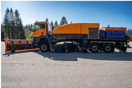
La CJS-DI se monta de serie en el vehículo portador tipo chasis MAN TGS 18.320. Este vehículo de transporte tiene un diámetro de giro de 18 metros y ofrece la opción de dirección adicional del eje trasero para mejorar la agilidad. El equipamiento básico y las emisiones de gases de escape del vehículo portador deben seleccionarse específicamente para cumplir las normas del cliente y del país correspondiente.
