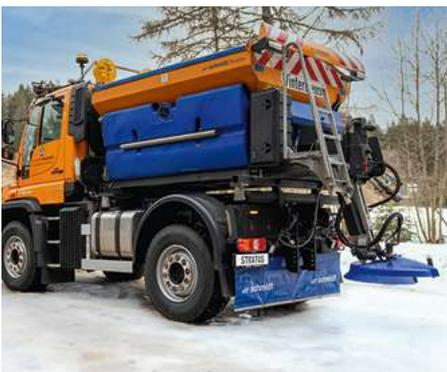
Der eStratos 25 ist eine Streumaschine mit einer Behältergröße von 2,5 m<sup>3</sup>.
