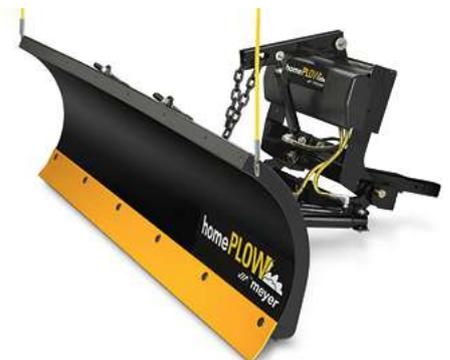
Este modelo proporciona lo último en rendimiento de arado con una **vertedera de 6'8"**. Ofrece un control hidráulico total para el movimiento hacia arriba y hacia abajo, y hacia la izquierda y la derecha mediante un controlador con cable.
